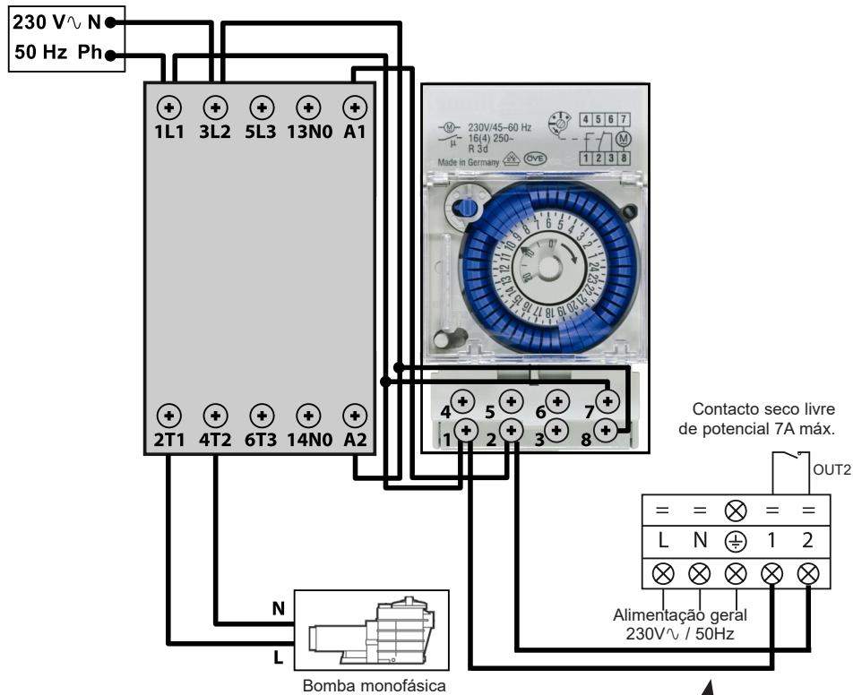
Os terminais 1 e 2 emitem um contacto seco livre de potencial, sem polaridade de 230 V~ / 50 Hz.
