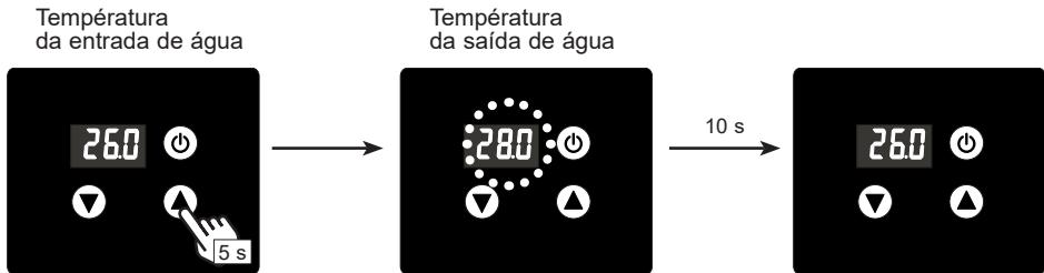
De seguida, regule o seu By-pass para obter uma diferença de 2° C entre a entrada e a de saída.
