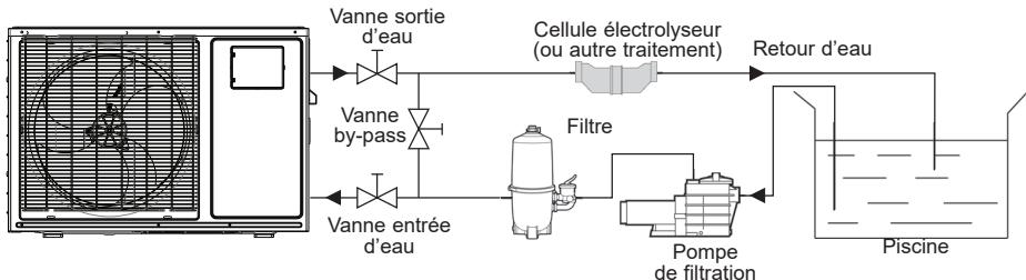
Note : La pompe à chaleur est fournie sans aucun équipement de traitement ou de filtration. Les éléments présentés sur le schéma sont des pièces à fournir par l'installateur.
