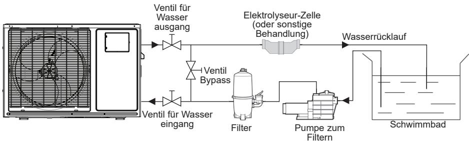
Anmerkung: Die Wärmepumpe wird ohne Behandlungs- und Filter-Element geliefert. Bei den auf dem Schema dargestellten Teilen handelt es sich um Bestandteile, die der Monteur zu liefern hat.
