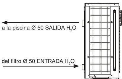
Instale una válvula de derivación entre la entrada y la salida de la bomba de calor.
