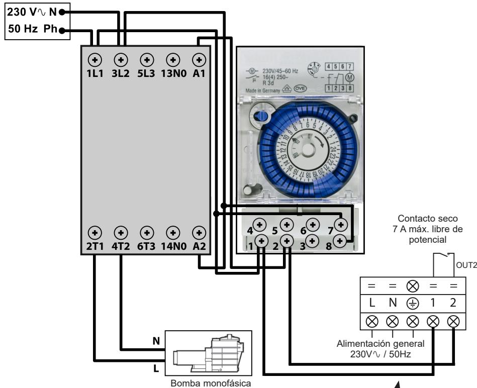
Los bornes 1 et 2 suministran un contacto seco (libre de potencial), sin polaridad de 230 V~ / 50 Hz.
