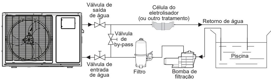
Nota: a bomba de aquecimento é fornecida sem qualquer equipamento de tratamento ou de filtração. Os elementos que constam do esquema são componentes a fornecer pelo instalador.
