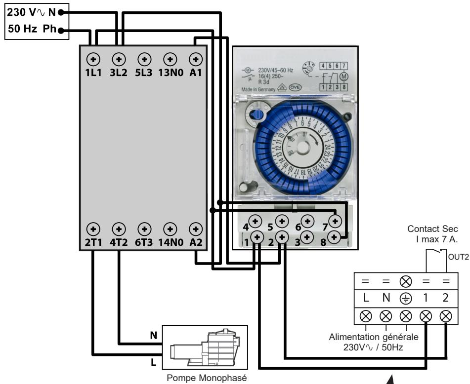
Les bornes 1-2 délivrent un contact sec libre de potentiel, sans polarité 230 V $\sim$  / 50 Hz.
