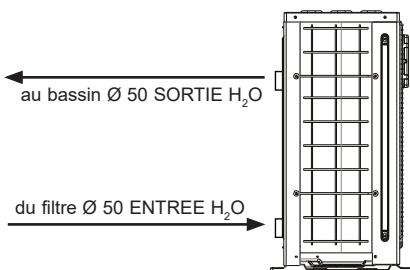
Installer une vanne dite "by-pass" entre l'entrée et la sortie de la pompe à chaleur.
