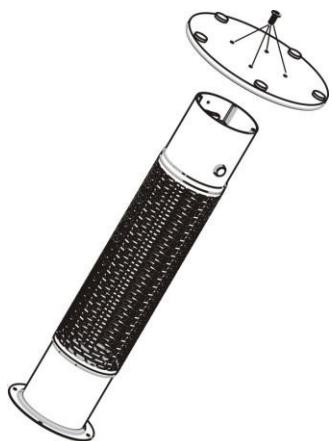
Schritt 2: Befestigen Sie den Heizkörper mit Glas mit 4 M5 \* 14mm Schrauben
