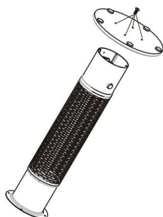
Etape 2: Fixez le corps de chauffe avec le verre à l'aide de 4 vis M5\*14mm
