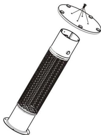
Passo 2: Fissare il corpo del riscaldatore con bicchiere tramite 4 pezzi di M5\*14mm viti
