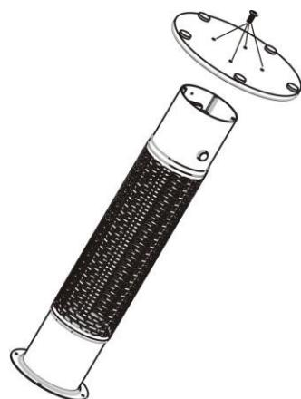
Paso 2: Fije el cuerpo del calentador al vidrio con 4 tornillos M5\*14mm.
