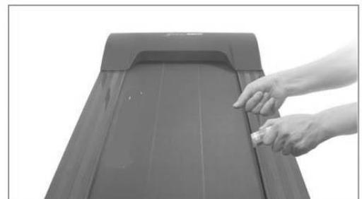
de silicone sur le marche-pied. Démarrez ensuite la machine pour qu'elle fonctionne 3 minutes sans charge. Il est préférable d'effectuer cet entretien toutes les 30 heures de fonctionnement de la machine. Cela permet de préserver la durée de vie des pièces.
