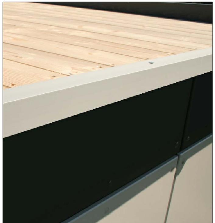
Après pré-perçage, fixez maintenant le rail en aluminium A100-220 (rail en angle) avec 10 vis B510 au bout du voligeage qui dépasse. Les rails en aluminium sont livrés en longueur standard de 220 cm et doit être recoupés. Ils devraient dépasser de 2 cm du bord sur la longueur.
