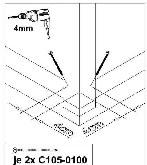
Redressez maintenant les parois et vissez ensemble les madriers de seuil à emboîter avec 2 vis C105-0050. Positionnez à la verticale les 3 poteaux d'angle restants et vissez-les en biais après pré-perçage avec 2 vis C105-100 sur le madrier de seuil. Afin d'éviter une collision des vis du support de la construction avec celles des plaques de façade, placez les vis de support à 4 cm du bord extérieur.
