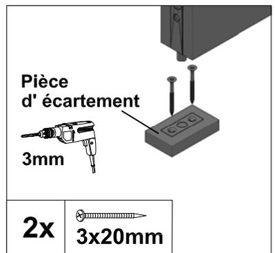
Ensuite, vissez les deux boulons de verrouillage à l'aide des vis 2x (3x40mm) après le pré-perçage dans les évidements prévus en haut et en bas. Puis, vissez les deux feuilles ensemble en utilisant les vis 2x (3x20mm) dans le haut du linteau et en bas dans le bas. (Ci-dessous, la feuille doit être relimée un peu avec une entretoise (sur place).
