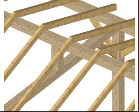
VISSAGE DES CHEVRONS (9) PAR VIS VBA 6 X 160 SUR SABLIERE POUR TERMINER
