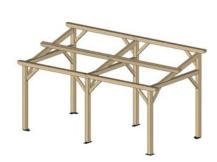
MISE EN PLACE DES PANNES A **DEVERS (3) ET (5) PAR VISSAGE VBA 6 X 200 SELON DETAIL EN ANNEXE.**
