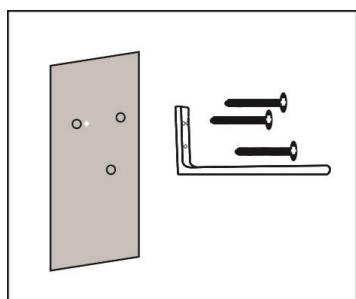
IV. Avant de fixer le chauffage, assurez que l'interrupteur d'alimentation à bascule se trouve sur le côté droit, puis fixez le support et le chauffage à l'aide de deux vis M6\*14 et d'écrous papillons
