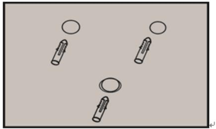
III. Fissare il supporto con tre ST4\*35 viti ed assicurare che i punti d'installazione fissati in sicurezza
