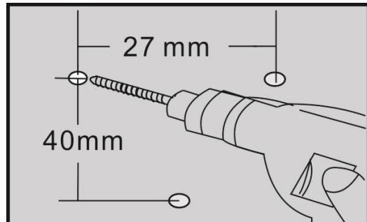
II. Inserte los tres anclajes de plástico para pared a los tres orificios.
