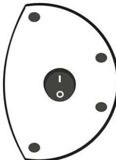
El interruptor de alimentación basculante en el lado derecho se dedica a controlar el encendido/apagado.
