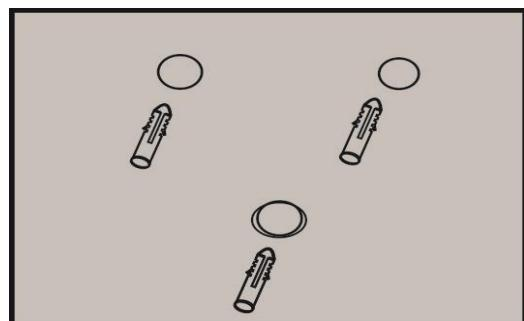
III. Fije el soporte con tres tornillos ST4\*35 y asegúrese de que los puntos de instalación estén bien fijados.
