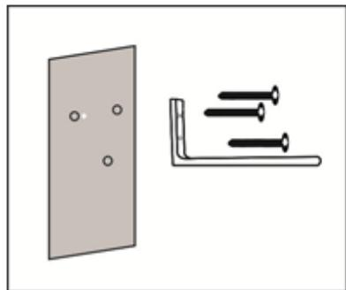
IV.Prima di fissare il riscaldatore, assicurare che l'interruttore d'alimentazione rocker al lato destro e poi fissare il supporto ed il riscaldatore con due viti M6\*14 e dadi a farfalla.
