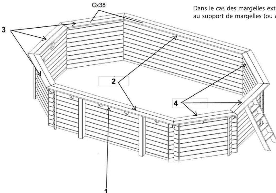
Dans le cas des margelles extérieures, il faut les fixer au support de margelles (ou au renfort d'escalier sur la paroi avec l'escalier) à travers la margelle à l'aide de 2 vis. Dans le cas des margelles intérieures, il faut les fixer à travers la margelle au support de margelle et à l'ossature bois (2 vis) et à l'endroit du croisement des parois de la piscine (2 vis).
