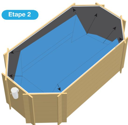
Le liner peut se rétracter ou se détendre. **Ne tendez pas trop le liner.**
