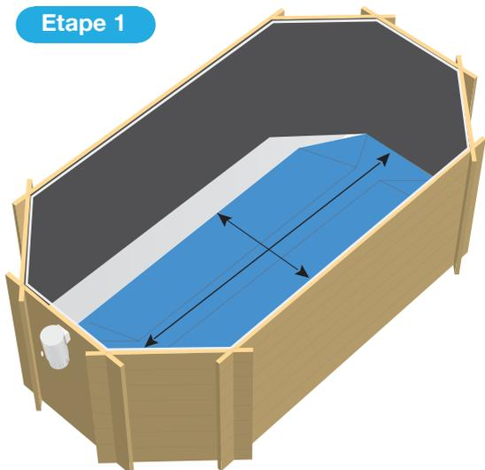
Aucune tête de vis ou écharde ne doit dépasser de la structure. Afin de ne pas endommager le liner, mettre un morceau de scotch sur chaque tête de vis par sécurité.
