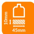
Utiliser des cales caoutchouc isolantes (non incluses) sur chacun des madriers au contact du sol.
